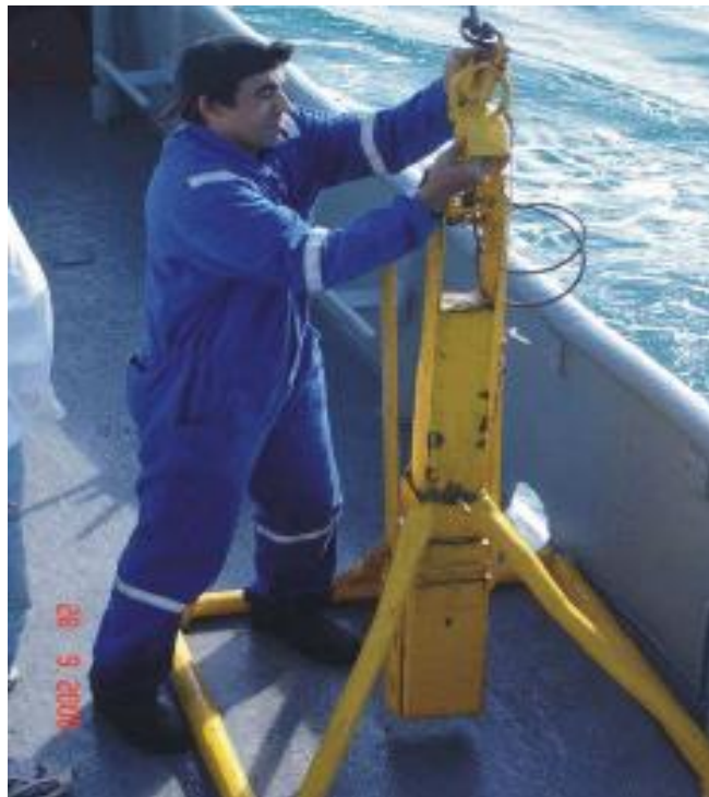
Figura 10 - Coletor tipo Box-core utilizado para amostragem de sedimentos na plataforma continental de Cabo Frio.
